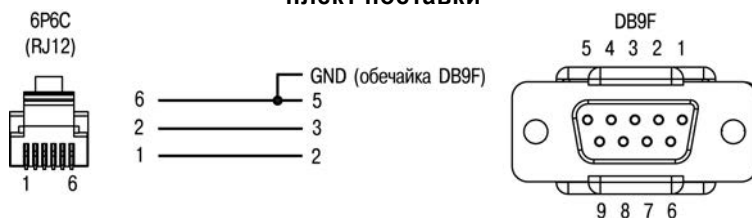
Рисунок В.2 – Схема кабеля программирования KC2
